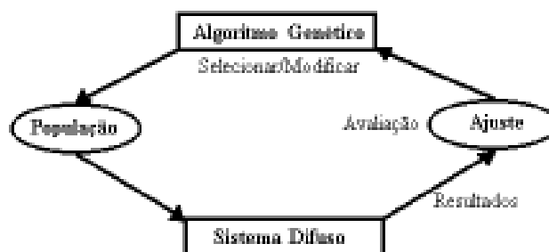
FIGURA 1 – Processo global para uso de um algoritmo genético a fim de melhorar o desempenho de um sistema difuso
